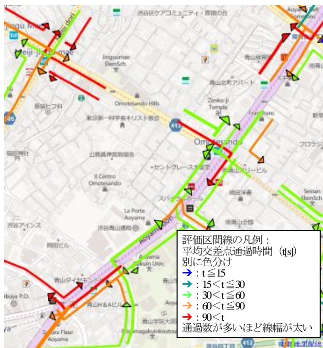
図-16 1日平均1回以上取得可能な直進以外の評価区間(表参道交差点付近)
